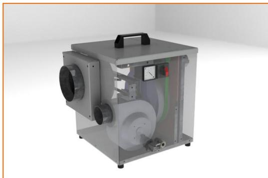
I nostri deumidificatori **Serie DC**, costruzione standard in AluZink® con pannellature semplici e/o isolate 25 mm, AISI 304 a richiesta - Portata aria da  $150 \text{ m}^3/\text{h}$  a  $2500 \text{ m}^3/\text{h}$ , tutti i modelli sono implementabili con accessori come: Filtrazioni particolari, batterie fredde, regolazioni ecc.
