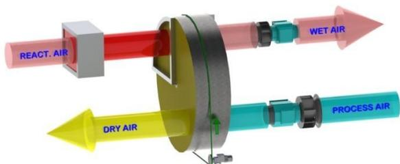
Supporto materiale in fibra con diametro  $\geq 6$  micron (non inalabile da essere umano) Silica gel 82%; Area pori  $600 \text{ m}^2/\text{g}$  - Superficie acrilica 2% con resistenza meccanica  $\geq 200 \text{ kPa}$ . La tecnologia produttiva dei rotori **DryCall** è brevettata, **Sweden – No 513238, USA – No US6265030 B1**. Il materiale del rotore è certificato non infiammabile (**Report Intertek Testing Service INC.** in accordance with
