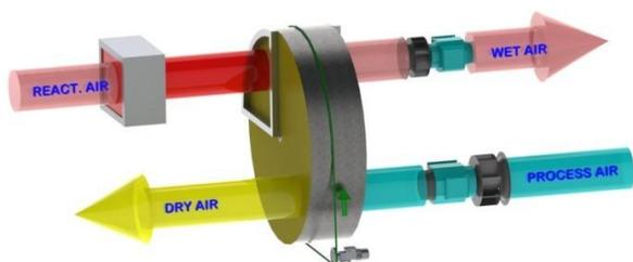
Supporto materiale in fibra con diametro  $\geq 6$  micron (non inalabile da essere umano) Silica gel 82%; Area pori 600 m<sup>2</sup>/g - Superficie acrilica 2% con resistenza meccanica  $\geq 200$  kPa. La tecnologia produttiva dei rotori **DryCall** è brevettata, **Sweden – No 513238, USA – No US6265030 B1**. Il materiale del rotore è certificato non infiammabile (**Report Intertek Testing Service INC.** in accordance with
